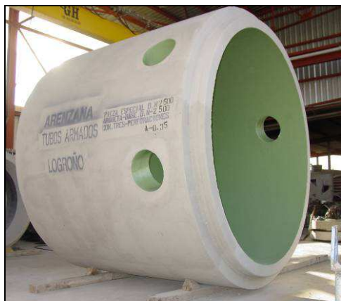
Tubería de saneamiento revestida de Epoxi verde para saneamiento de aguas residuales en el polígono industrial Las Cañas (Logroño).
